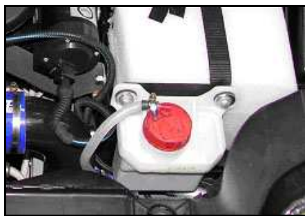
Figura 21: Circuito raffreddamento compressore e ausiliari, vaschetta acqua e glicole.
