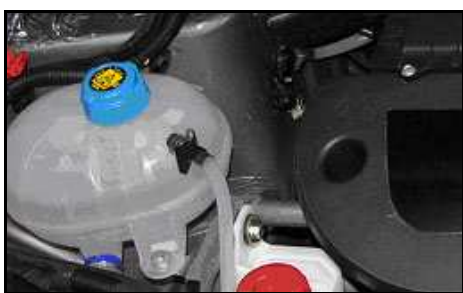
Figura 19: Circuito raffreddamento stack, vaschetta acqua demineralizzata.
