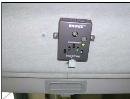
Figura 11: Sensore concentrazione/fughe idrogeno.
