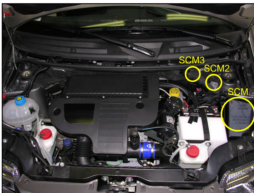
Figura 12: Vano anteriore, centralina fusibili e porta fusibili.
