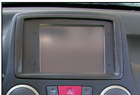
Figura 4: Display multifunzione "touch-screen".
